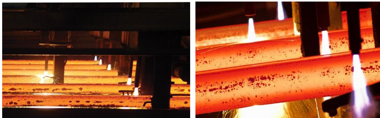
شکل ۳ - برش شمش‌های فولاد با شعله اکسیژن
